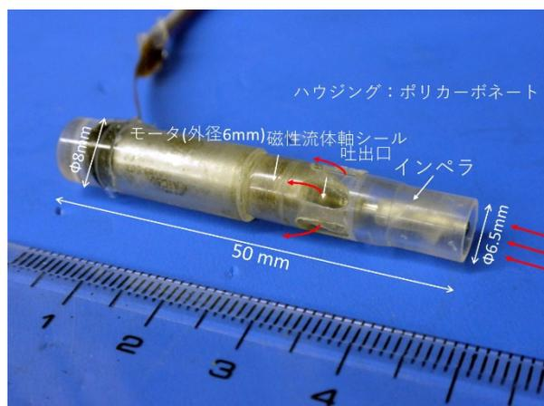
図1 磁性流体軸シールを用いた超小型軸流血液ポンプ
